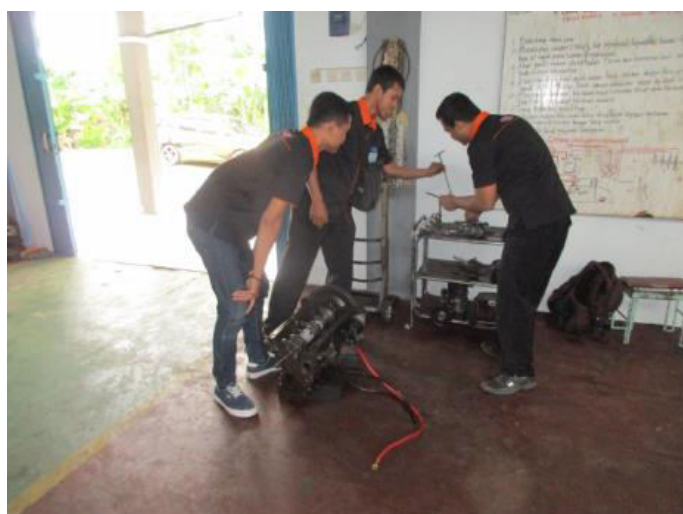
Memelihara/servis sistem injeksi bahan bakar diesel
